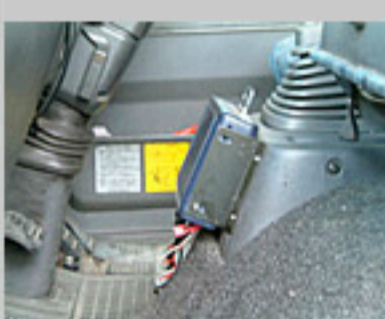
トラックに設置された運行管理システムの端末。会社に戻った時点で端末のボタンを押せば、内部に蓄積された運行データが社内のコンピュータに送信される
